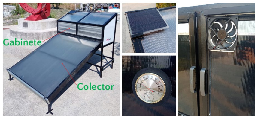
Ilustración 7. Deshidratador solar mixto tipo gabinete y sus partes
