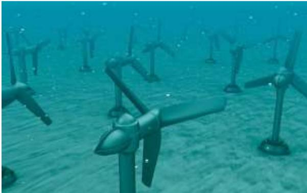
Nota: Es aquella que se genera mediante el movimiento de las mareas. Cuando estas suben y bajan, su movimiento es aprovechado para poner en marcha unas turbinas que hacen funcionar al resto del conjunto mecánico del alternador, creándose así energía eléctrica. (TotalEnergies, 2022)
