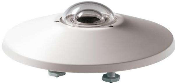
Nota: Sensor de radiación solar Global que se aplica en observaciones generales de alta precisión (DARRERA, 2020)
