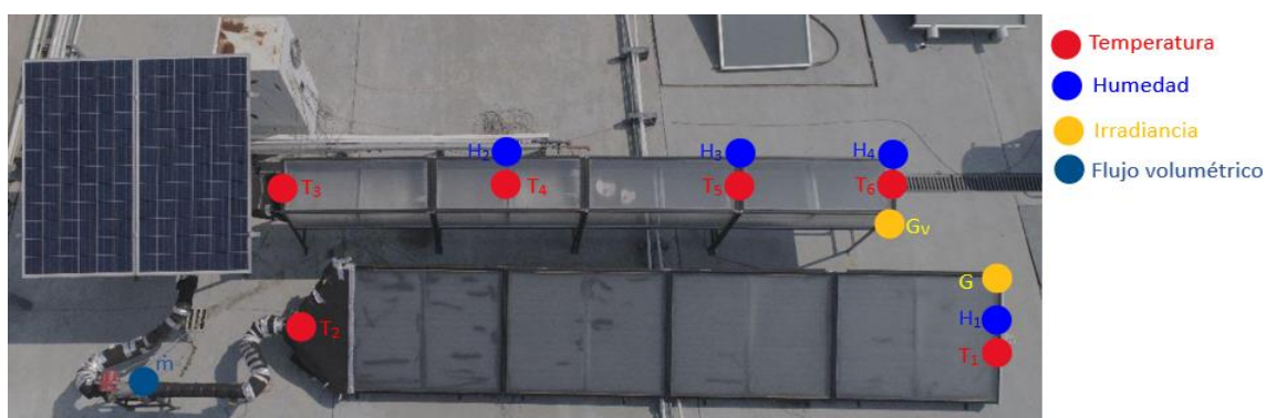
Figura 1: Ubicaciones de sensores de temperatura, humedad, flujo e irradiancia.
