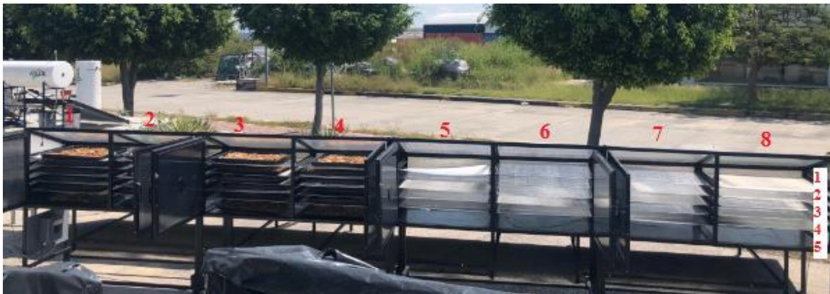
Figura 6 Distribución de charolas en el túnel de secado
