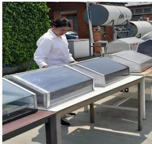
Figura 1, Secadores solares modificados: de izquierda a derecha a) superficie selectiva de óxido de titanio, b) policarbonato oscuro, c) policarbonato claro
