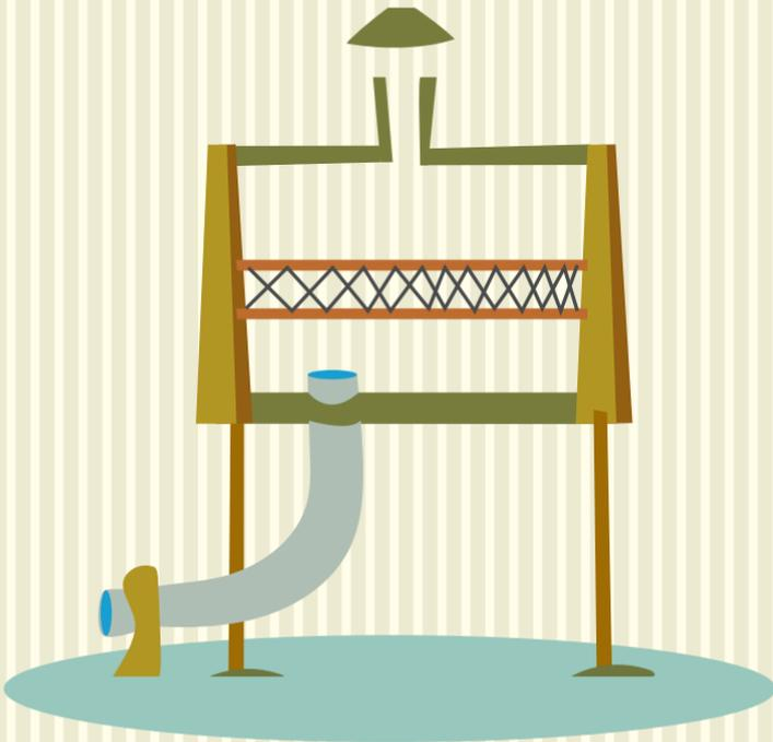
No creas que toda la comida se seca directamente al Sol, como nosotros lo hicimos con las bandejas. Por suerte, ahora existe el secador solar que es una técnica más eficiente porque protege al alimento del ambiente, con tiempos de secado mucho más cortos y donde se puede tener un mayor control en la calidad e higiene de los alimentos.
