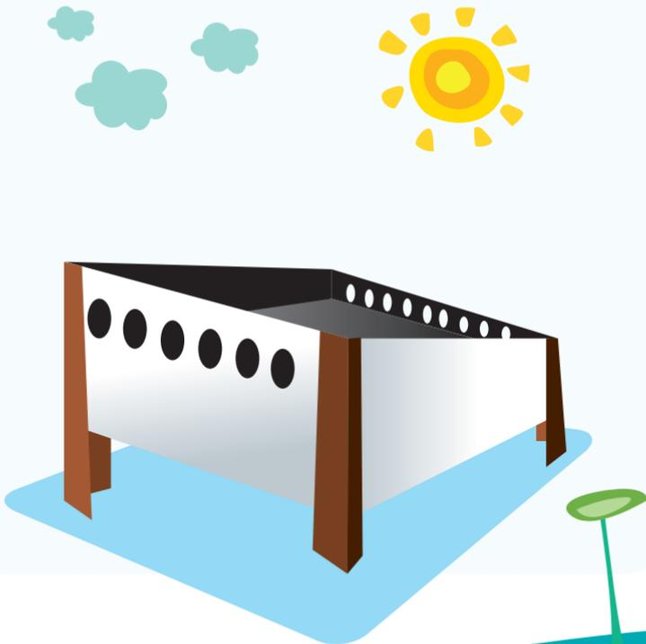
20. Es importante que la cubierta transparente de la caja o secador solar, se abra y cierre adecuadamente. Para ello, en su parte superior, coloca elementos que permitan que se abra, como bisagras, tela, cintas adhesivas, etcétera. En la imagen se utilizó cinta gris, que une la parte superior con la parte trasera.
