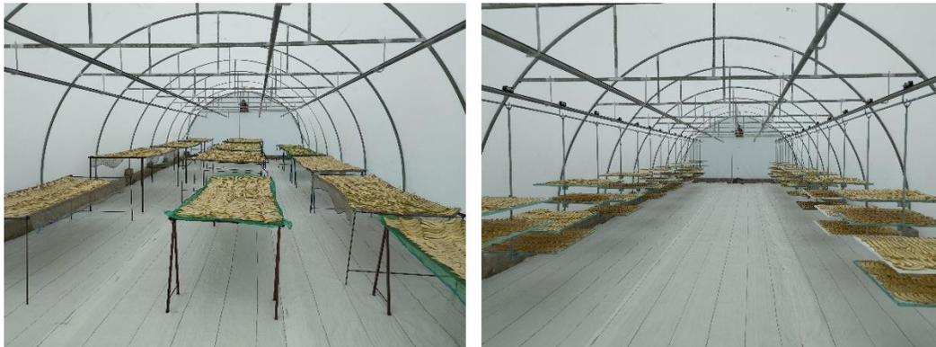
**Figura 11 Secador solar tipo invernadero de la planta harinera**
