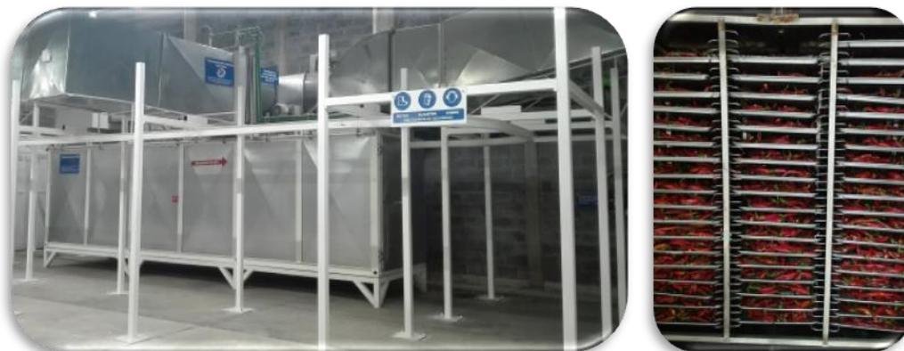
**Figura 7** Cámara de secado tipo túnel semicontinua con interiores de acero inoxidable.
