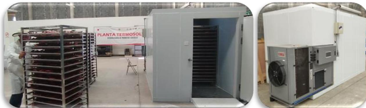
Figura 10 Secador de alimentos tipo bomba de calor
