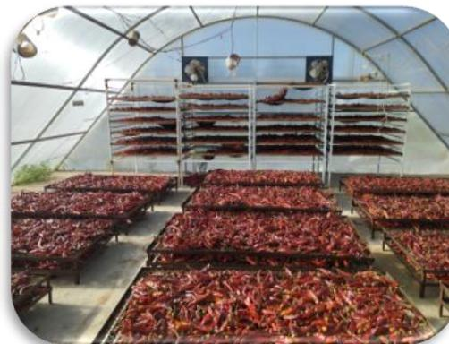
Figura 5 Secado solar integral tipo invernadero de policarbonato
