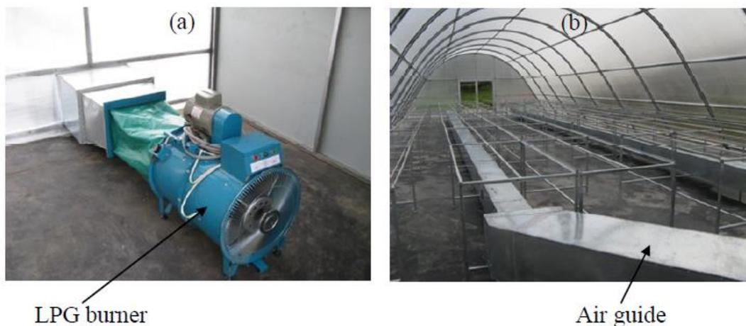
Figura 6 Una vista pictórica del quemador (a) y las guías de aire (b).
