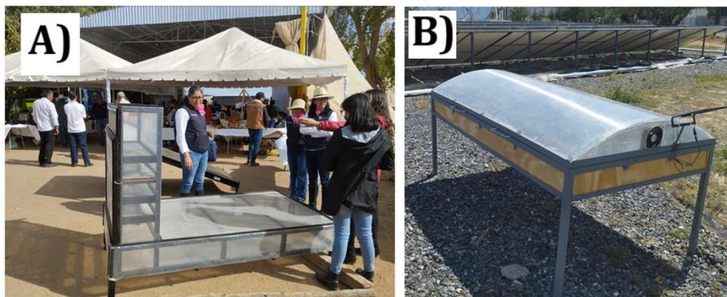
**Figura 4 Secadores solares directos: A) cubierta de plástico y estructura de madera; B) cubierta de policarbonato y estructura de metal**
