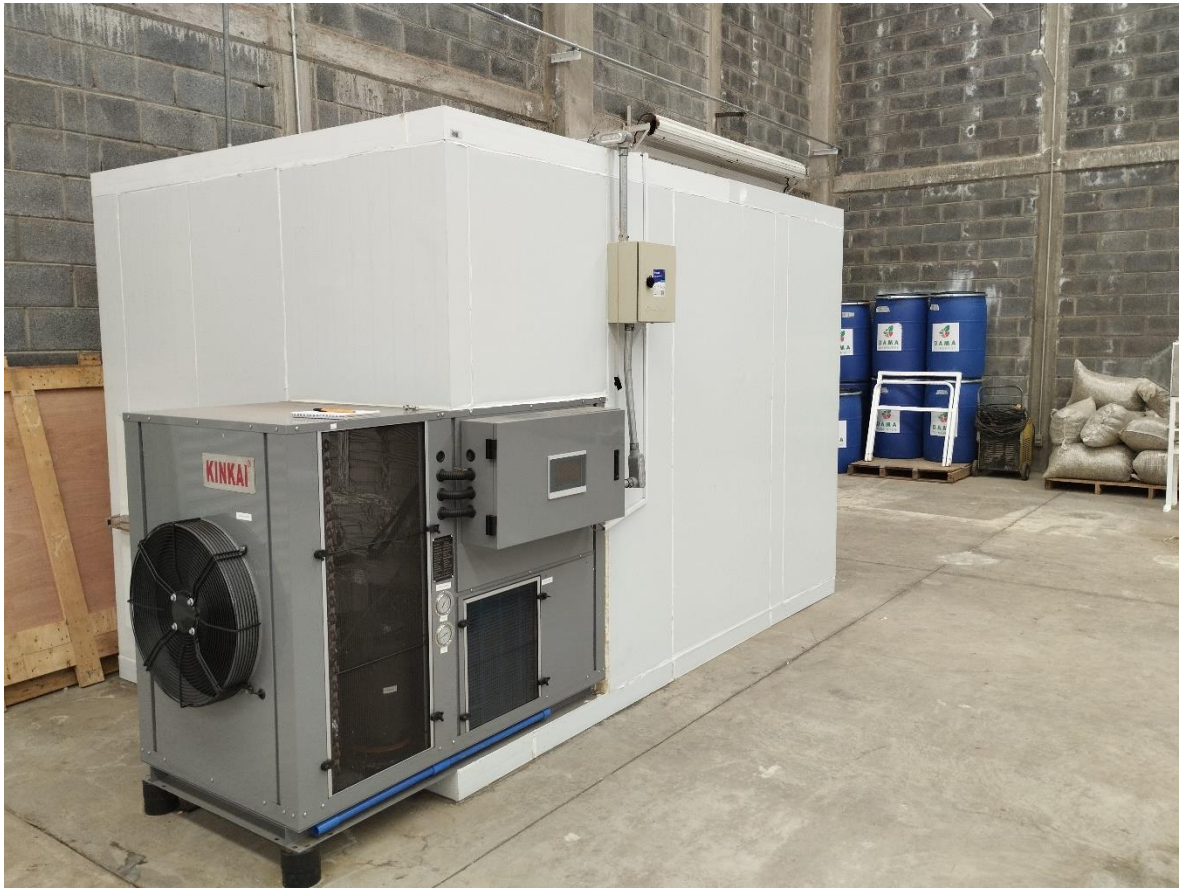
Figure 3 Bomba de calor acoplada a una cámara de secado de alimentos
