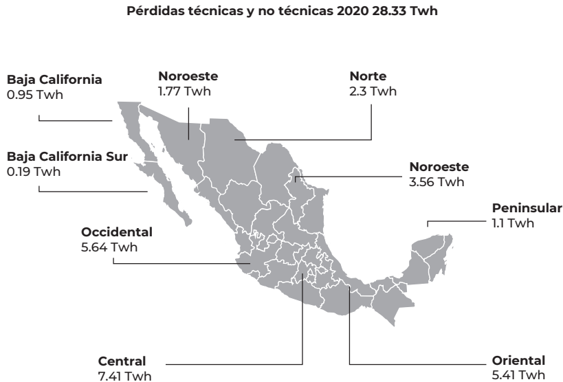
Figura 12. Pérdidas técnicas y no técnicas en las Redes Generales de Distribución, por región de control (2020)
