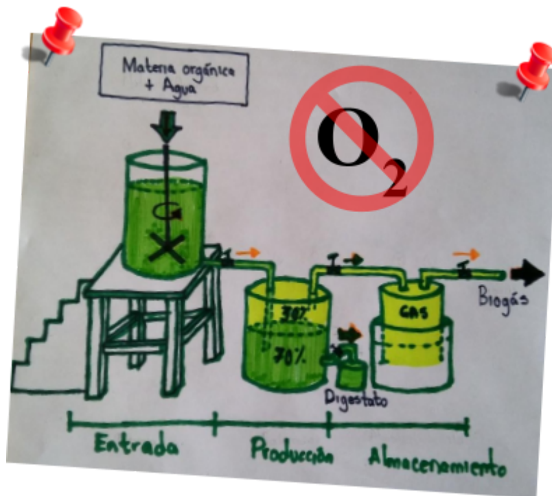
Figura 1. Esquema proceso de producción de biogás.
