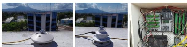
Figura 2. a) piranómetro CMP 11; b) biómetro 501A; c) sistema de adquisición de datos CR3000. Instrumentos instalados en la estación de la Red Solarimétrica Mexicana en la Universidad Autónoma de Nayarit.
