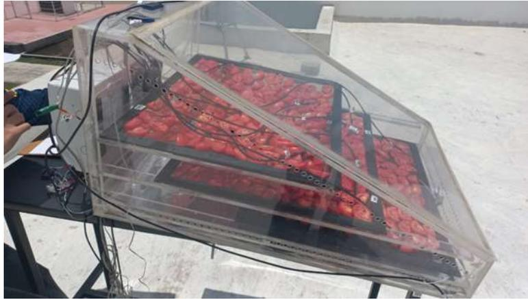
Figura 11. Deshidratador solar de acrílico
