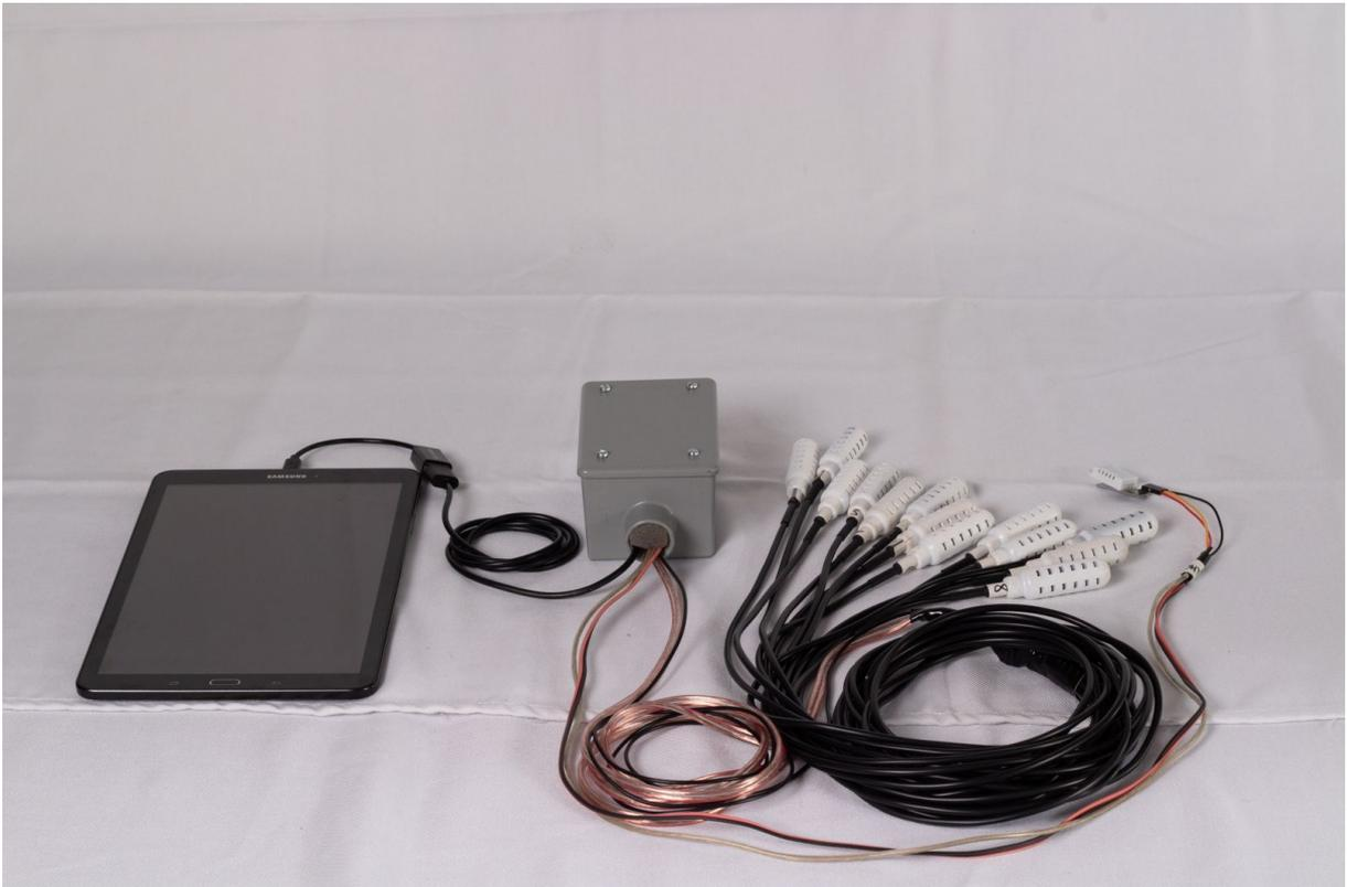
Figura 3.34: Sistema adquisición de datos.
