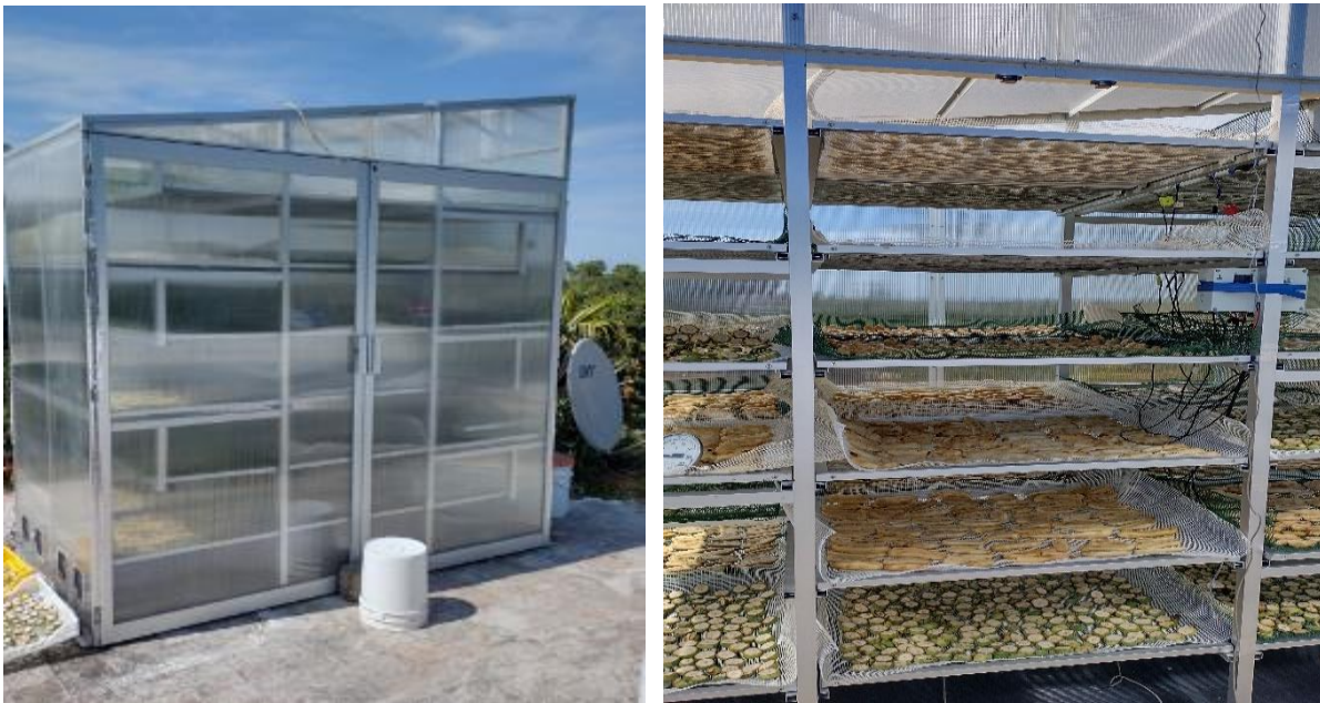
Figura 17-Secador directo tipo invernadero con distribución de charolas y colocación de sensores de temperatura y humedad en secador directo tipo invernadero familiar.
