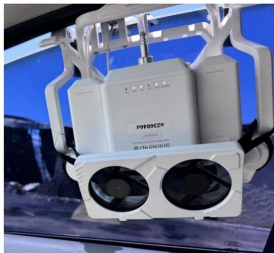
**Figura 17.** Sensor Sniffer 4D utilizando montura para vehículos terrestres.
