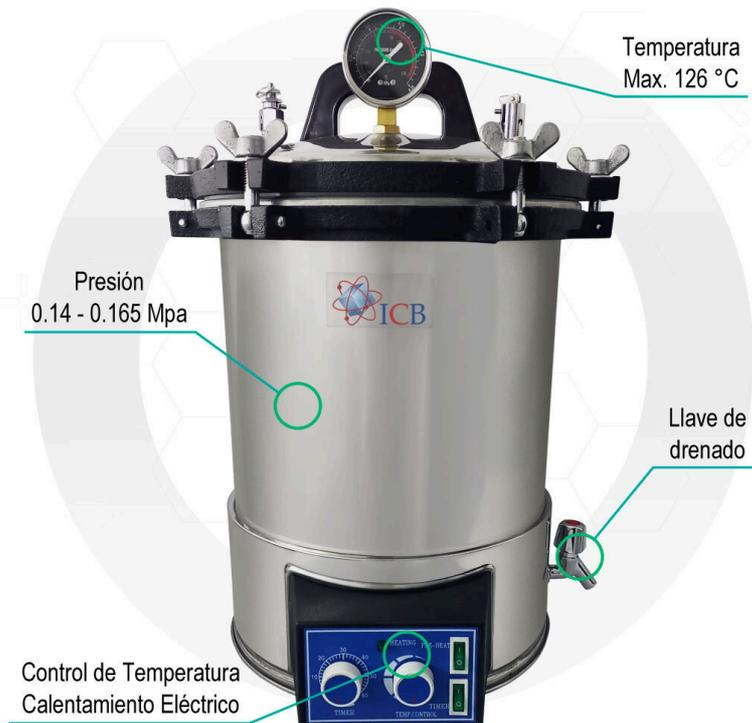
Ilustración 4. Características técnicas de la olla autoclave
