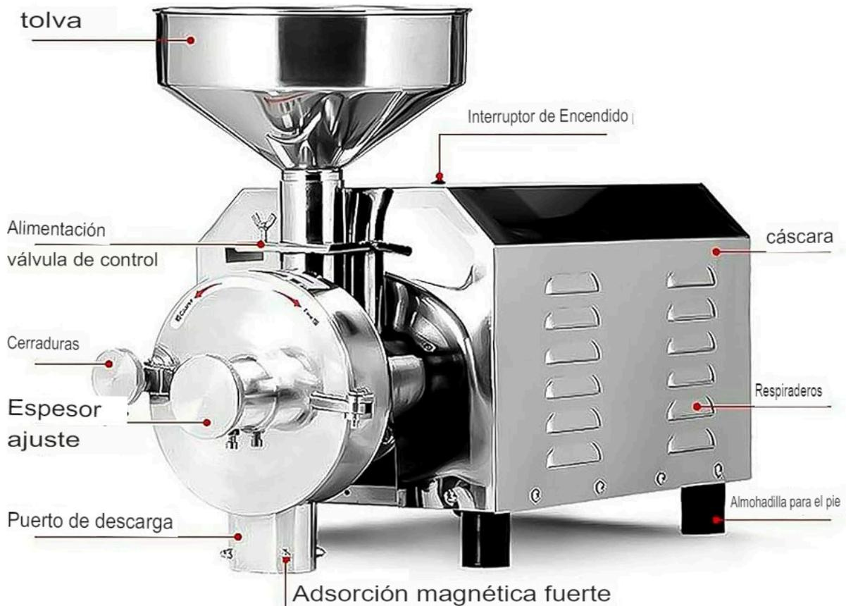
Ilustración 4. Características técnicas del molino de especias
