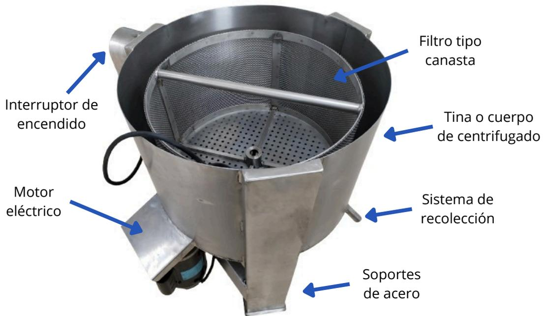
Ilustración 4. Características técnicas de la centrifugadora de filtración
