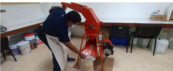
Ilustración 5. Molino de martillos en operación
