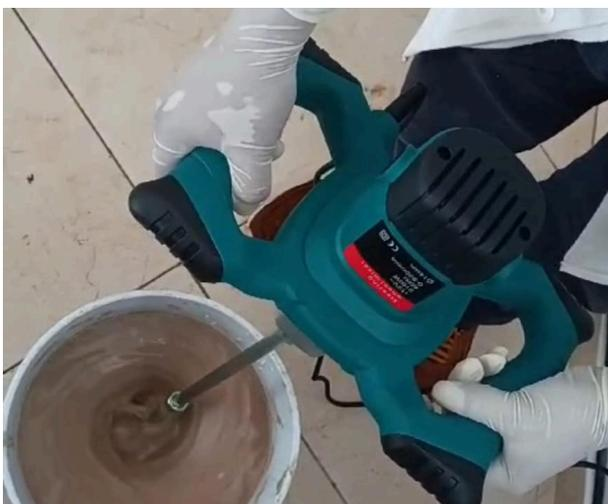
Ilustración 5. Mezclador eléctrico en operación
