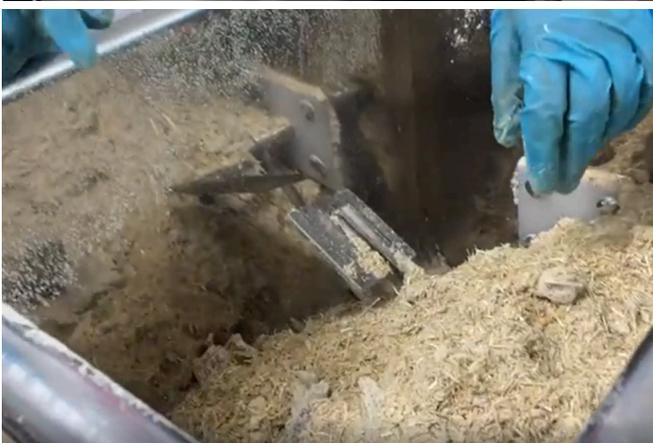
Ilustración 5. Mezcladora de paletas en operación
