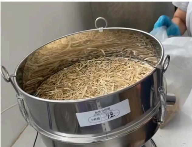
Ilustración 5. Cribadora automática en operación
