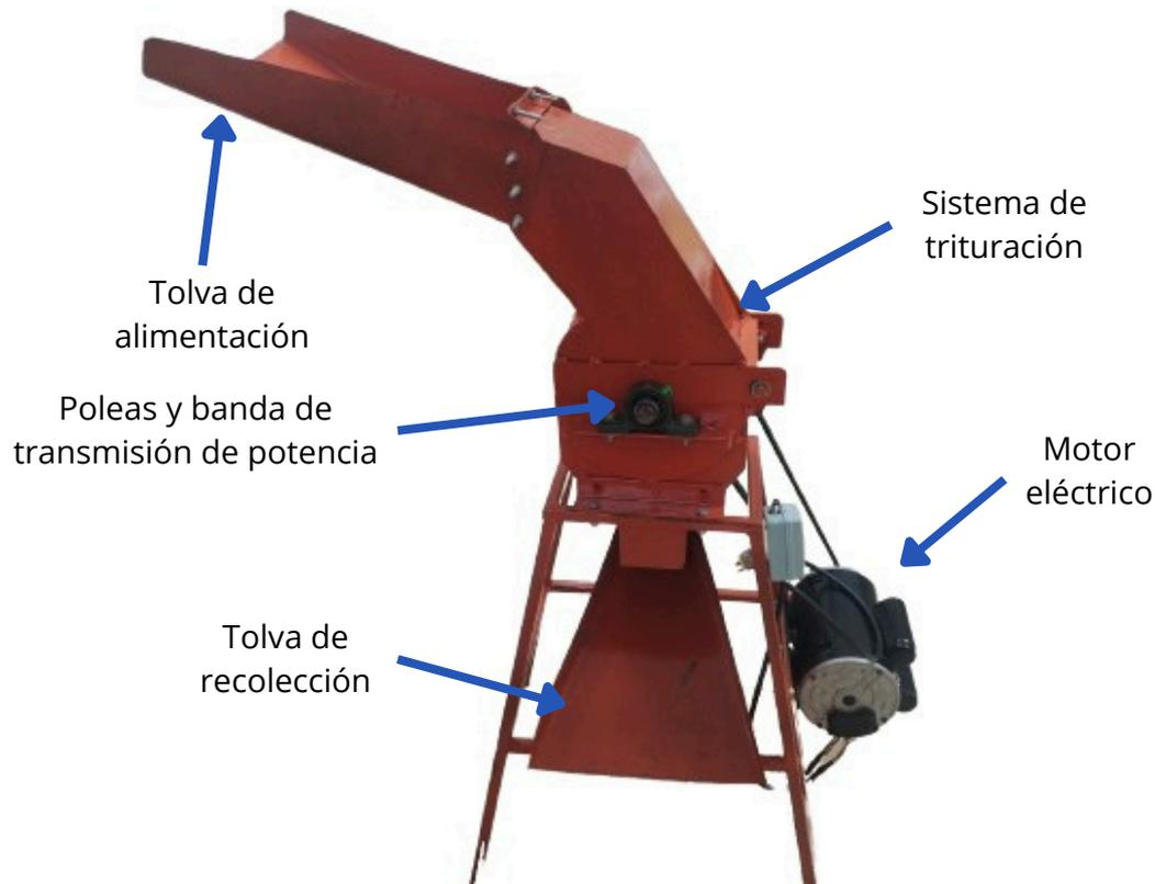
Ilustración 4. Características técnicas del molino de martillos
