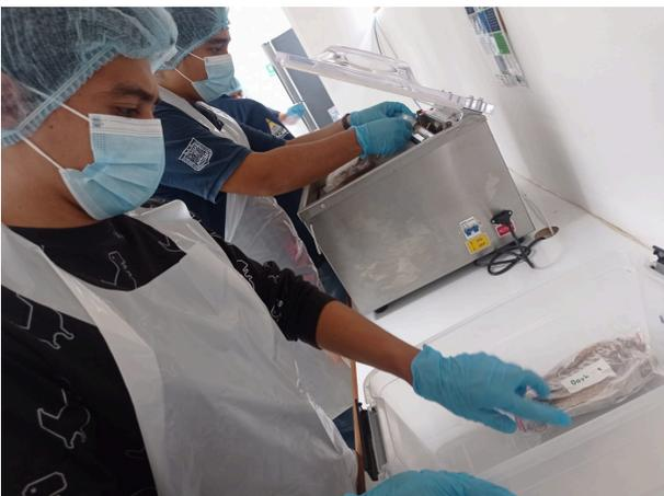
Ilustración 5. Selladora al vacío en operación
