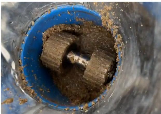
**Ilustración 5. Peletizadora de alimentos en operación**
