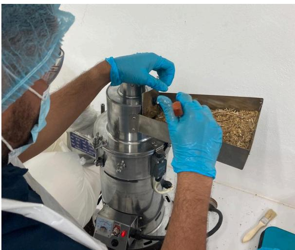
**Ilustración 5. Molino pulverizador en operación**
