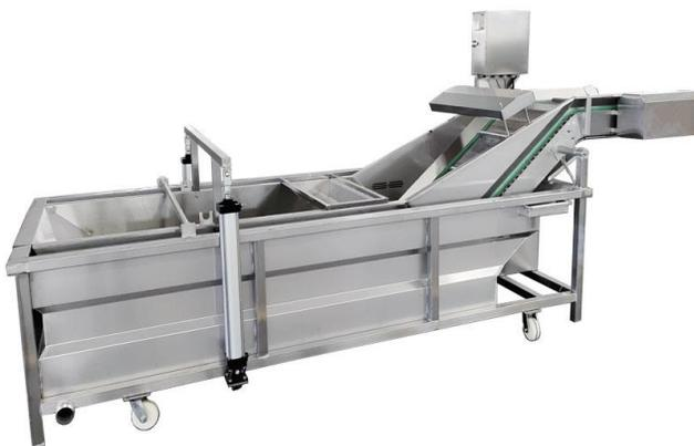
Una lavadora por inmersión es un equipo diseñado para limpiar y descontaminar productos como pescado fresco o mariscos mediante la inmersión en un líquido limpiador o desinfectante. El líquido de lavado puede ser agua fresca o una solución desinfectante suave, dependiendo de los requisitos de limpieza y desinfección del proceso.
