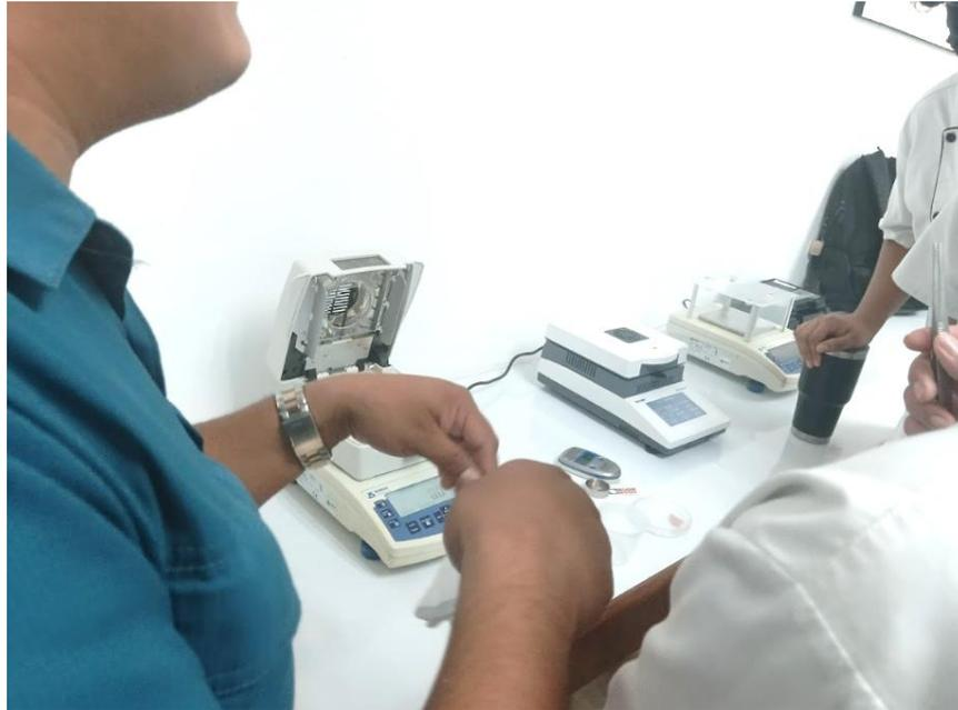
Figura 4. Demostración del equipo de laboratorio para medir la actividad del agua y el contenido de humedad.
