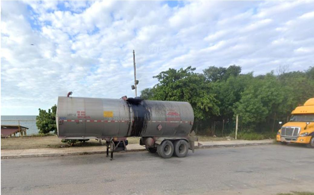
Figura 8. Tanque que transporta combustóleo, con indicios de un derrame durante las maniobras de carga y descarga.
