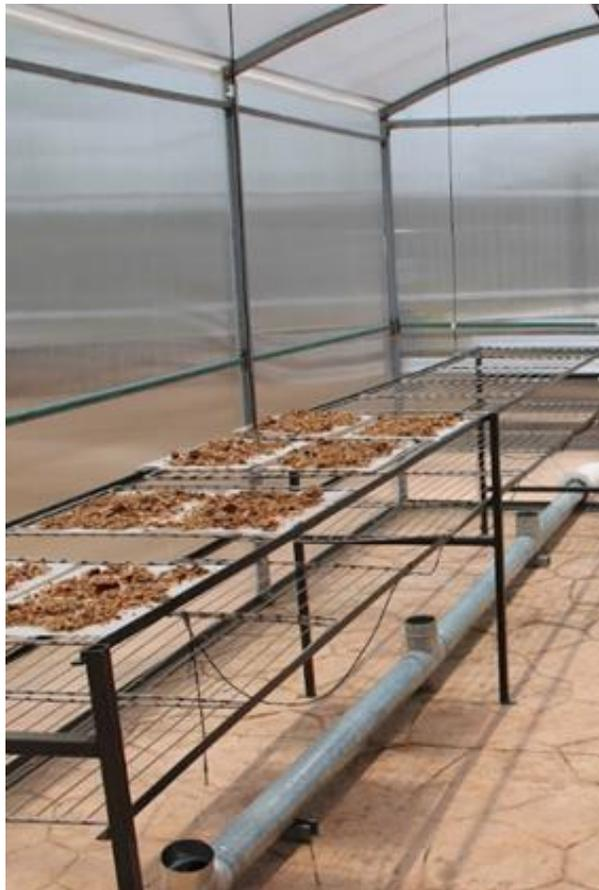
Figura 8. Interior del secador solar tipo invernadero
