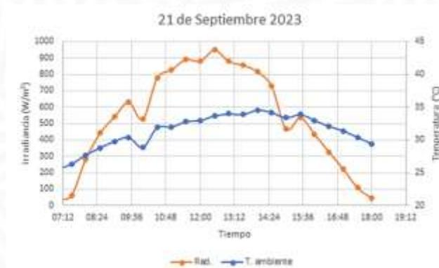
Figura 4. Irradiación y temperatura durante el proceso de secado solar
