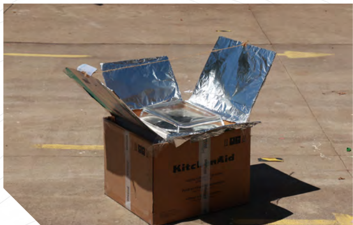
Un deshidratador solar elaborado con materiales reciclados
