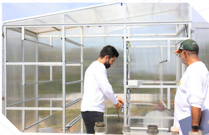
El deshidratador solar se equipa con diferentes instrumentos para medir la humedad, irradiancia, masa, entre otros elementos para comprobar su eficiencia
