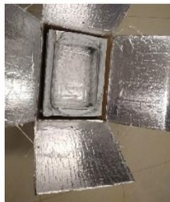
**4.** El diseño final debe contener el uniceil dentro de la caja de cartón para almacenar el calor, la tapa de vidrio, para permitir la entrada de luz, y las cuatro superficies reflectoras, unidas a la caja de cartón.
