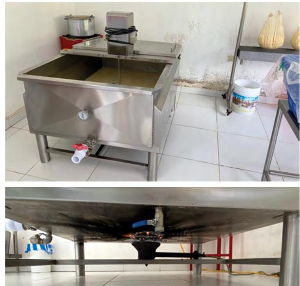
Figura 4. Tina quesera para pasteurización de leche, con doble fondo lateral y sistema de quemador a gas LP.
