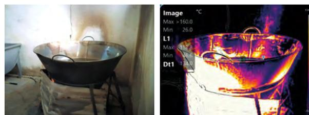
Figura 2. Imagen del cazo de calentamiento de agua y su imagen térmica durante el proceso de calentamiento de agua con un quemador a gas LP en el fondo del recipiente.
