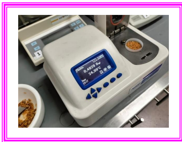
Figura 14. Equipo AQUALAB para la determinación de la actividad del agua (Aw).
