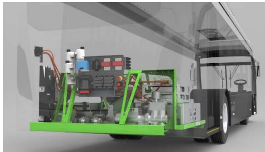
Figura 155.- Perspectiva de sustitución de motor de KLEANBUS.
