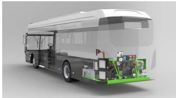
Figura 154.- Esquema de montaje en parte trasera de autobús de KLEANBUS.
