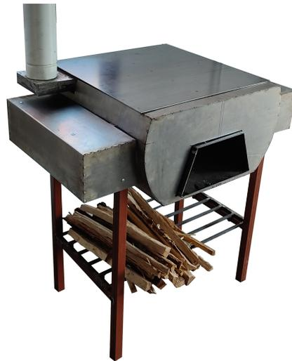
Figura 2.18. Prototipo a escala real de la estufa de tipo plancha y portátil de flujo lateral cruzado.
