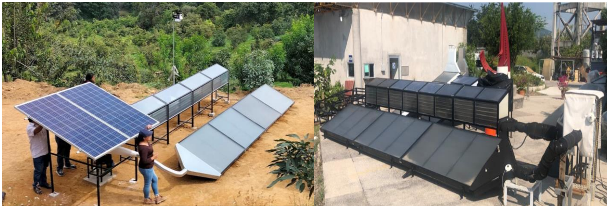
Figura 3 a) Secador solar tipo túnel ventilador fotovoltaico b) secador solar tipo túnel ventilador eléctrico
