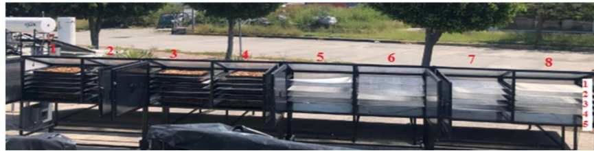
Figura 4 Secador solar tipo túnel en un prueba de secado con irradiación de 12.3 MJ/m 2 , humedad relativa ambiental de 48.6 % y una temperatura ambiente de 34.2 °C.
